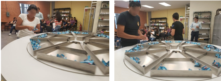
Figura 100. Procedimiento de muestreo aleatorio por parte de los operadores para la obtención de veinte subgrupos de cinco
