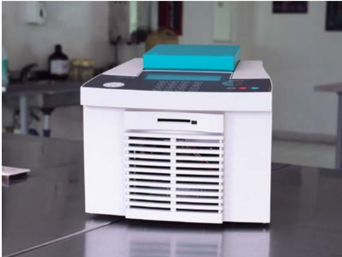
Termociclador y equipos complementarios. Éstos permiten realizar amplificación de ADN a través de la técnica Reacción en Cadena de la Polimerasa, PCR por sus siglas en inglés.
